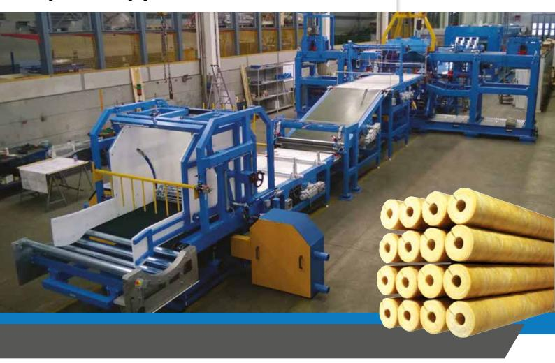
Линии производства цилиндров Gamma Meccaniса производить готовые изделия для специальных применений с использованием продуктов, полученных с основных технологических линий. Эти линии характеризуются высокой эффективностью и производительностью, они могут работать как со стекловатой, так и с каменной ватой.
