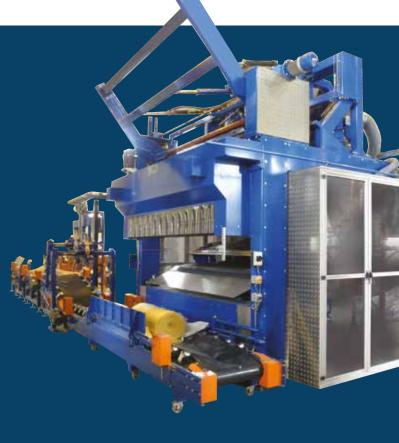
Полная технологическая линия для производства стекловаты состоит из комплекса машин, которые преобразуют смесь кварцевого песка и других компонентов в плиты и/или ковёр из стекловаты (полимеризованные или нет).
