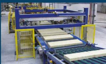
Полная технологическая линия для производства каменной ваты состоит из комплекса машин, которые обрабатывают материал, начиная от смешивания и плавления сырья и заканчивая упаковкой готовых изделий.
